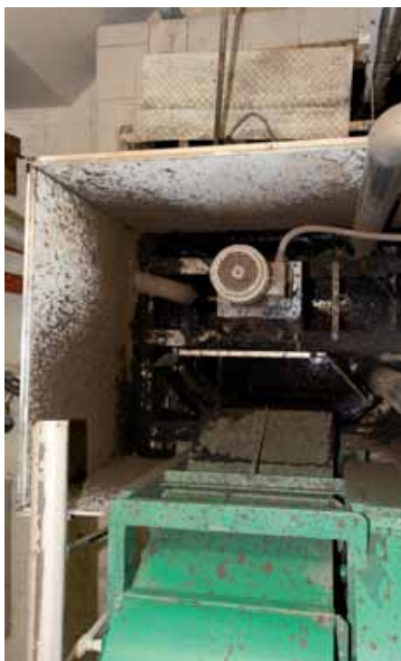
↑ Pohled shora na drtič rašeliny, měsnou nádrž a kalové čerpadlo.
